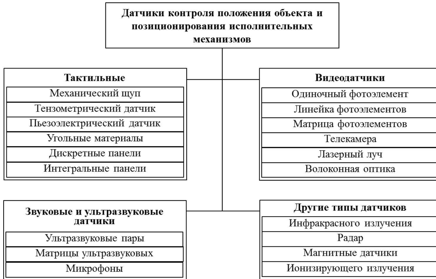
Рисунок 4.11 – Классификация датчиков роботизированных комплексов
