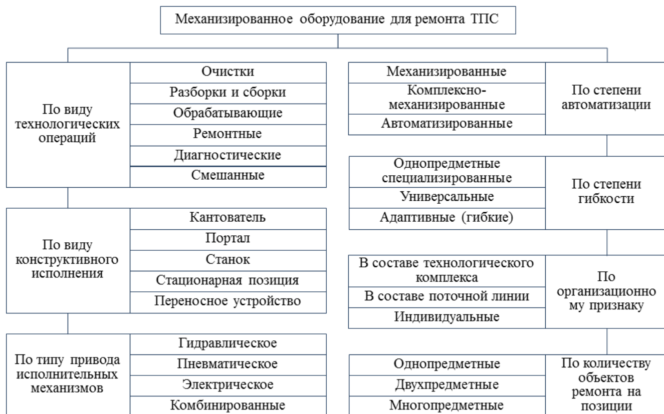
Рисунок 1.6 – Классификация механизированного оборудования для ремонта ТПС
