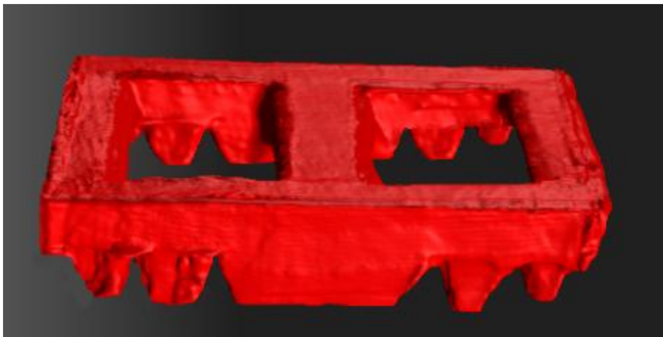
Рисунок 4.13 – Трехмерная модель макета тележки подвижного состава, полученная в результате лазерного сканирования
