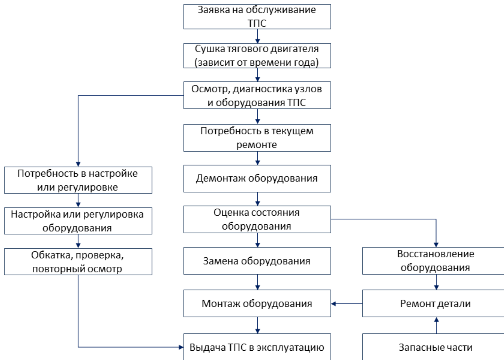
Рисунок 1.8 – Структурная схема технологического процесса технического обслуживания ТПС
